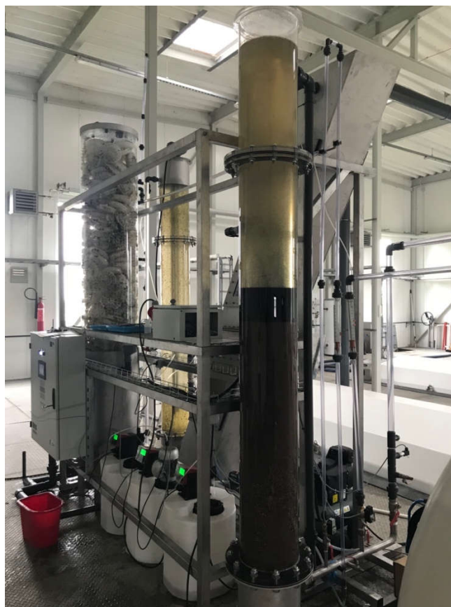
12 pav. Bandomasis įrenginys, sukurtas įgyvendinant projektą BEST (angl. „Better Efficiency for Industrial Sewage Treatment“), finansuojamą pagal INTERREG Baltijos jūros regiono programą. Iliustracijoje pavaizduotą konfigūraciją sudaro smėlio filtras ir GAA.
